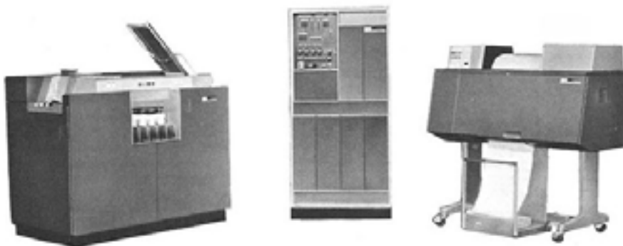
Figuur 1: Het welbekende IBM 1401 mainframe, met van links naar rechts de 1402 kaartlezer en puncher, de 1401 processor en opslagruimte en de 1403 printer.
