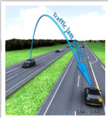
Afbeelding 1: Car-to-car waarschuwing bij het naderen van een file
